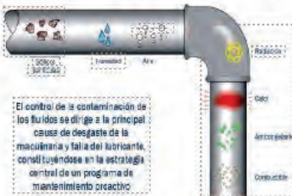
El control de la contaminación de los fluidos se dirige a la principal causa de desgaste de la máquina y falla del lubricante, constituyéndose en la estrategia central de un programa de mantenimiento proactivo
