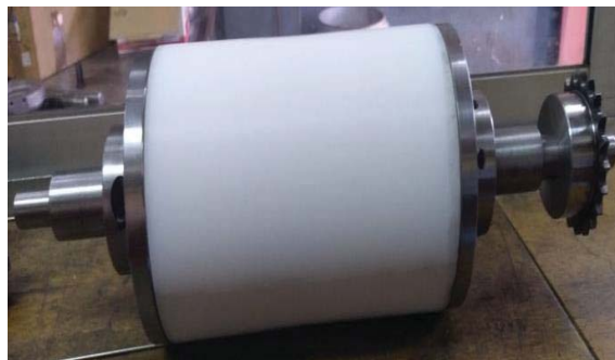
RODILLO ENCOLADOR ACERO - POLIETILENO
