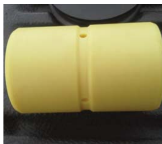
REEMPLAZO BUJES DE ACERO Y BRONCE POR POLIAMIDAS LUBRICADAS
